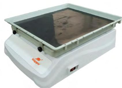
Orbitaler Schüttler zur Homogenisierung der Mischung des bereits rekonstituierten Verdünnungsmittels.
