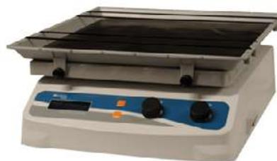
Agitateur orbital pour homogénéiser le mélange du diluant reconstitué.
