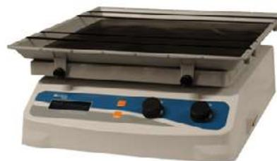
Orbitaler Schüttler zur Homogenisierung der Mischung des bereits rekonstituierten Verdünnungsmittels.
