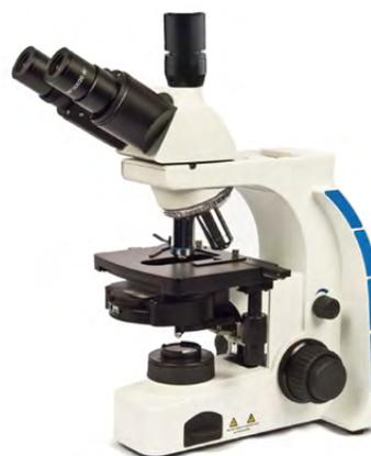
**MASTER 7** Усовершенствованный тринокулярный микроскоп. С оптикой UCIS и оснащен функциями светлого поля, темного поля, поляризатора и отрицательного фазового контраста. Адаптируется для систем CASA и опции с обогреваемым столиком. Объективы: 4x - 10x - 40x - 100x и 10x негатив
