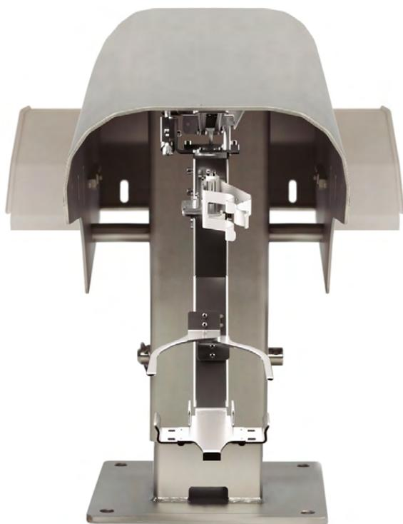
Ergosダミー内に設置できるモバイルガイドと、オートコレクト頸管と魔法瓶を取り付けるためのモバイルエレメントで構成されています。
