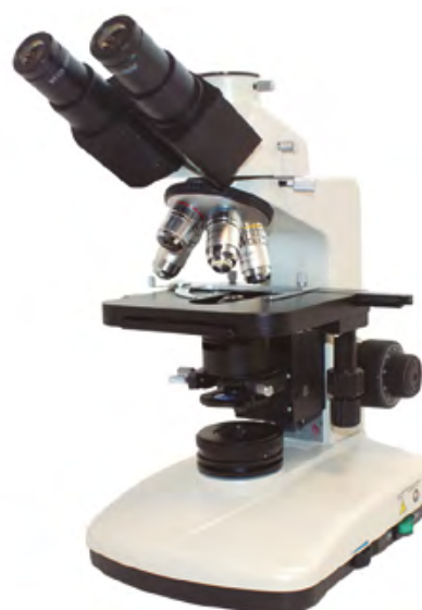
MASTER 5 三眼顕微鏡 位相コントラストを組み込む可能性を提供します。 対物レンズ: 4X - 10X - 20X - 40X - 100X
